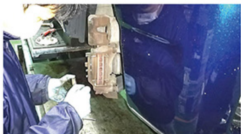
ブレーキパッドも取り外し残りのミゾをチェック
